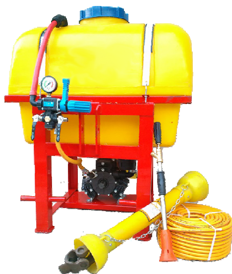
شکل ۱۲: سم پاش هیدرولیک پشت تراکتوری سوار شونده
